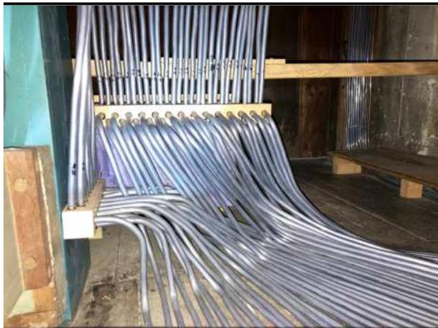
Nicht alle Tontraktur-Teile der Orgel sind mit neuen Bleirohren versehen worden. Die Bleirohre von 2004, die über Holzwinkel bis unter die Schwellwerkklade geführt sind (vorne links) wurden belassen. Hinten rechts sind neue Bleirohrstränge (hell glänzend) zu erkennen.
