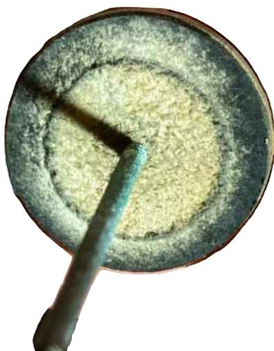
Kegel mit originalem Dämmfilz innen.
