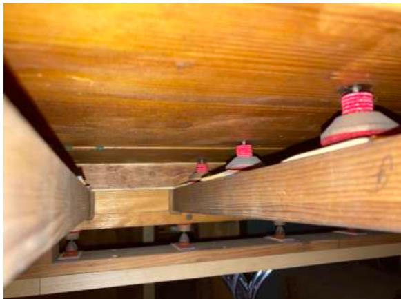
Unterschiedliche Kegelventile als Registersteuerung und als Tonsteuerung.
