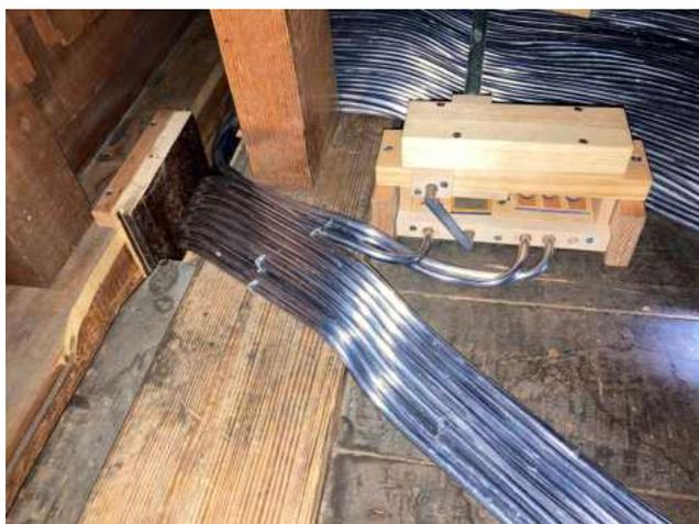
Zur Realisierung der im ehemaligen Tönninger Spieltisch vorgesehenen und in Altenbochum nicht originalen Funktion: „Rohrwerke ab“ konstruierte die Fa. Scheffler eine neue Umschaltstation. (Links)
