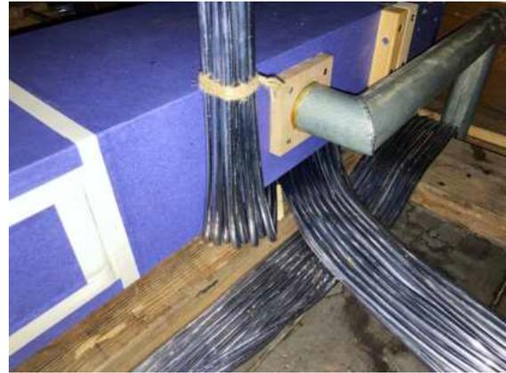
Neue Kanäle wurden unterhalb der Unterlade des I. Manuals konstruiert und eingebaut.
